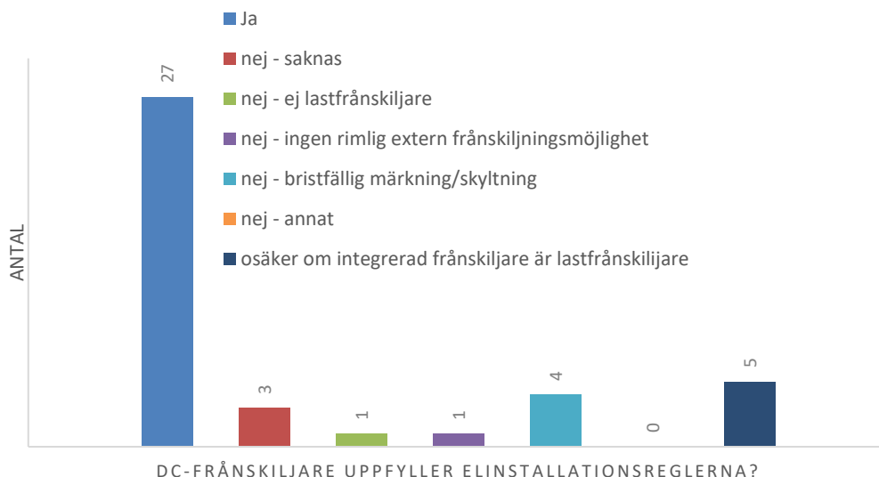
Figur 11 Ett antal olika krav ställs på utförandet av frånskiljare som ska kunna användas för att koppla bort solcellspanelerna elektriskt från resten av anläggningen.
